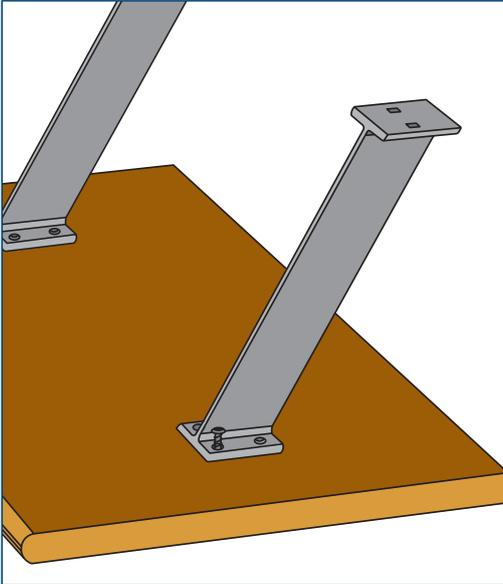
Posicionar los soportes en la parte inferior de la sobreencimera y fijarlos con los tirafondos.
